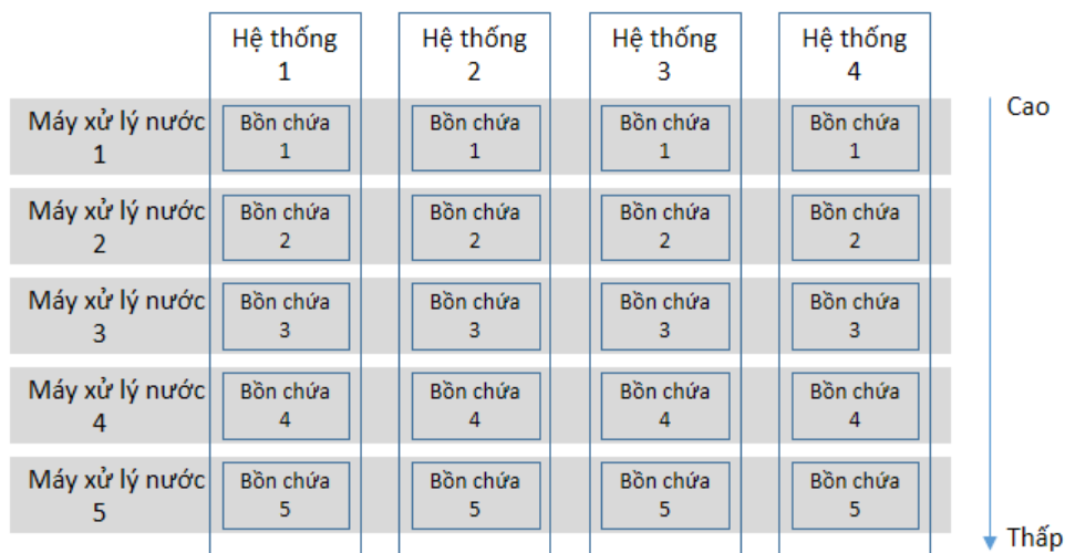
Hình minh họa mô hình có 4 hệ thống (mỗi hệ thống có 5 bồn chứa) và 5 máy xử lý nước.
